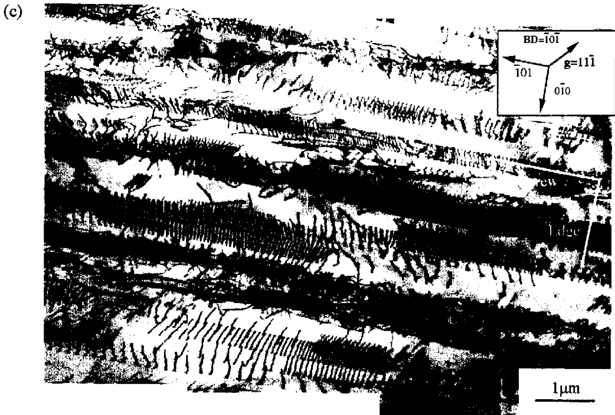
図7 室温で10%の引張り変形を与えた、(a)3元合金、(b)4元合金、および(c)複合添加合金(SPRON510)の透過電子顕微鏡観察による転位組織。
