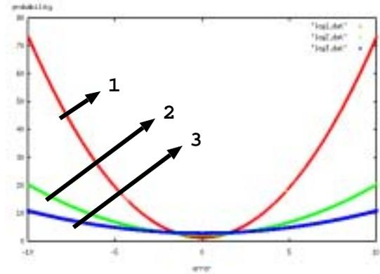
Fig. 6 Gauss分布を考えたときの偏差の記述長，偏差が大きい程記述長は長くなる．図中の数字は対応するグラフの分散値を表す．
