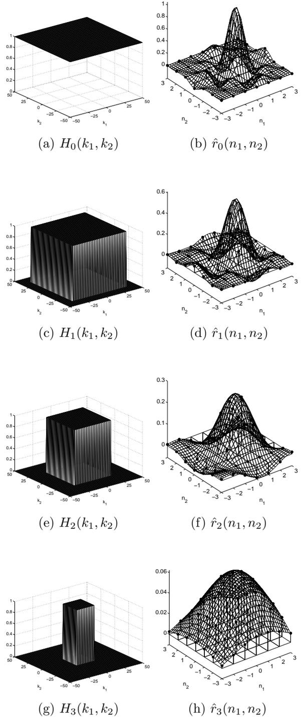
Fig. 2 重み付けスペクトルとそれに対応する位相限定相関関数 . (a)  $H_0(k_1, k_2)$ , (b)  $\hat{r}_0(n_1, n_2)$ , (c)  $H_1(k_1, k_2)$ , (d)  $\hat{r}_1(n_1, n_2)$ , (e)  $H_2(k_1, k_2)$ , (f)  $\hat{r}_2(n_1, n_2)$ , (g)  $H_3(k_1, k_2)$ , (h)  $\hat{r}_3(n_1, n_2)$
