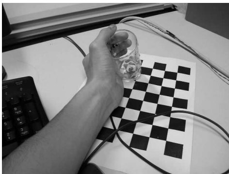
Fig. 8 道具を大きく傾けられた場合の例. 同色のマーカーがほぼ同じ座標にあり, 物体座標系上の点を投影しても区別がつかない
