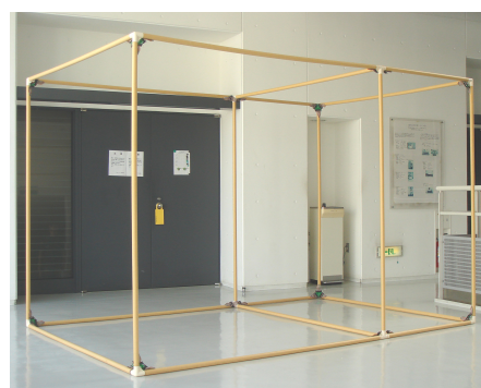
Fig. 11 本研究で作成した励磁コイル(直方体形状)
