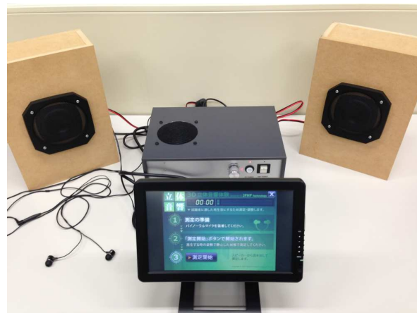
Fig. 7 H_\infty トランスオーラル再生を用いた3次元高臨場感再生装置
