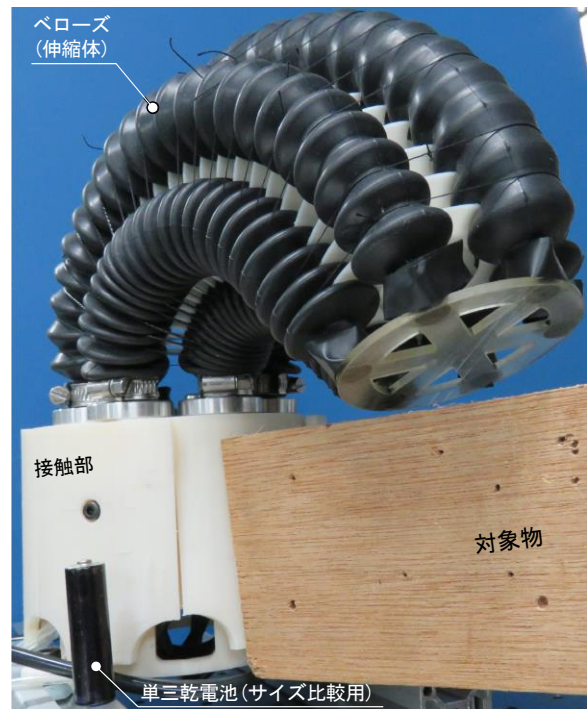
Fig.5 全方向反射的湾曲メカニズムの第一次試作機の外観
