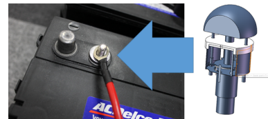
Fig. 4 緊急停止スイッチ 右側のスイッチで左のバッテリー端子とコードを接続、緊急時に押すことで接続を断つ
