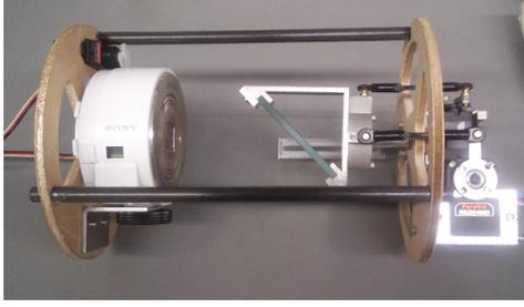
Fig. 11 ミラージンバル (実機)
