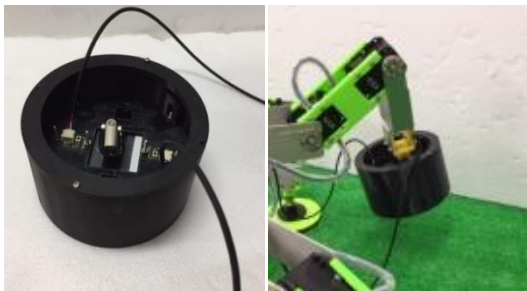
図3 可動式スパイクフットを取り付けたロボット
