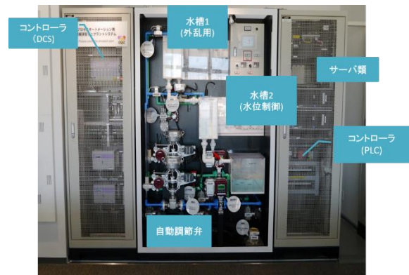
Fig.3 水槽システム模擬プラント
