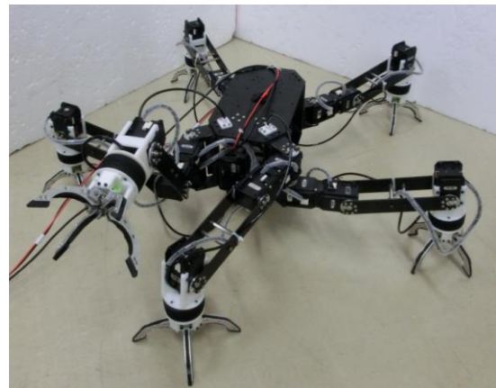
図 1 4 本指ハンドを備えた 6 脚作業移動ロボットの 5 脚 1 腕姿勢
