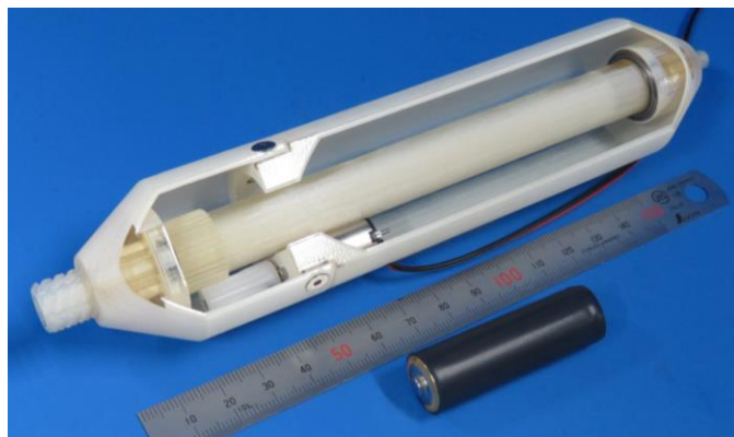
図5 入れ子型直動メカニズムの試作機の内部構造
