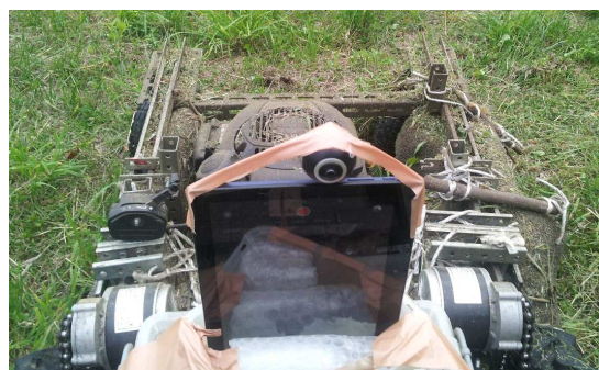
図 8 360 度カメラの取り付け状態
