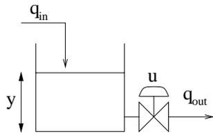
Fig. 7 液面制御プロセス
