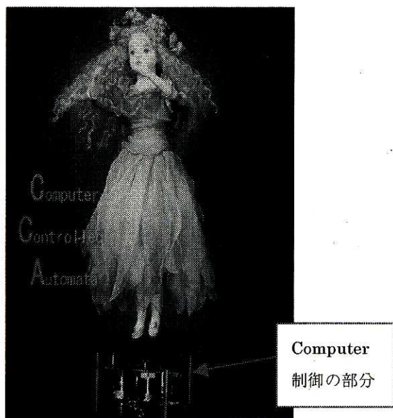
図 1. 5 自由度を持つダンスロボット
