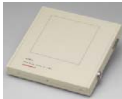
図 5.3 X線フラットパネルセンサ C7942 Fig. 5.3 X-ray flat panel sensor C7942
