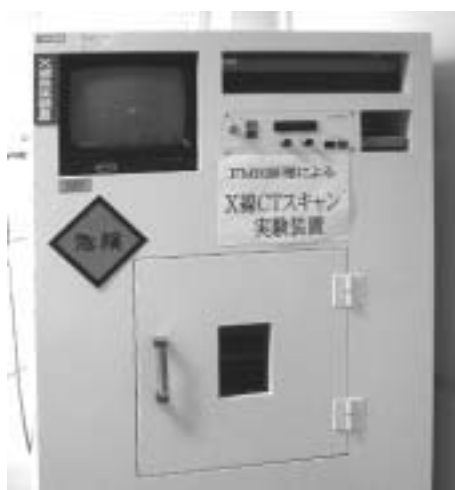
図 5.2 3次元X線CTシステム Fig. 5.2 Three-dimensional x-ray CT experimental system
