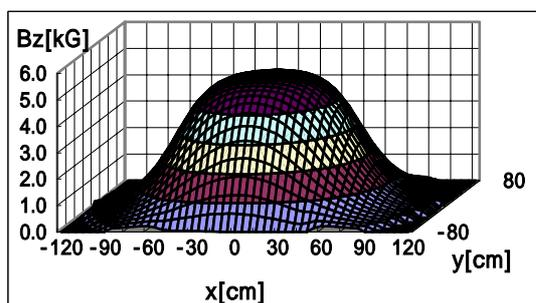
図 1-2  $z=0\text{cm}$  の水平面における磁場  $B_z$  の様子
