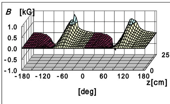
図 4-2  $r = 80\text{cm}$  における  $B_\phi$  の数値積分結果
