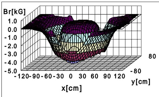
図3-6  $z=25\text{cm}$ の水平面における $B_r$ の様子
