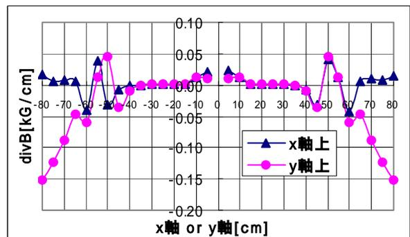
図 5-1  $x$  軸上と  $y$  軸上における  $\text{div} \vec{B}$  の様子
