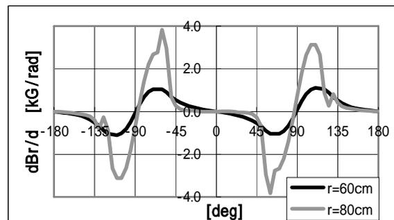
図3-8  $z=25\text{cm}$ のときの $\phi$ と $\frac{\partial B_r}{\partial \phi}$ の関係
