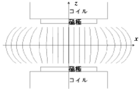
図 3-10  $xz$  平面( $x$  軸上)における磁力線の様子
