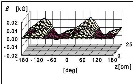
図 4-1  $r = 5\text{cm}$  における  $B_\phi$  の数値積分結果
