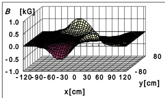
図 4-4  $z = 15\text{cm}$  の水平面における  $B_\phi$  の様子
