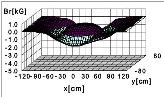
図3-5  $z=15\text{cm}$ の水平面における $B_r$ の様子
