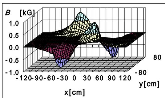
図 4-5  $z = 25\text{cm}$  の水平面における  $B_\phi$  の様子
