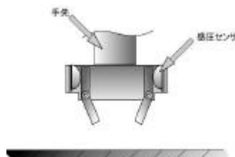
図 7 . 試作アタッチメント3 の構造
