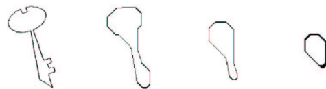
Fig. 4 Crystalline flowの例. Fig.1の離散版. 多角形のまま形の細部が消えていく。
