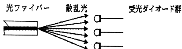
図2. 散乱光による測定の概念
