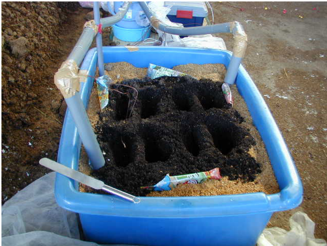
図9 堆肥からの回収熱を利用した植物栽培装置の核心部
