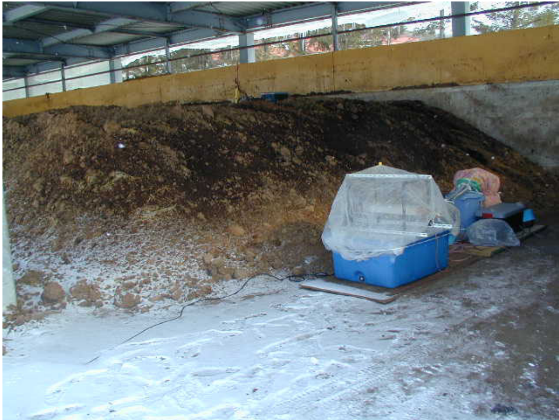
図 1 0 堆肥からの回収熱を利用した植物栽培装置の全容
