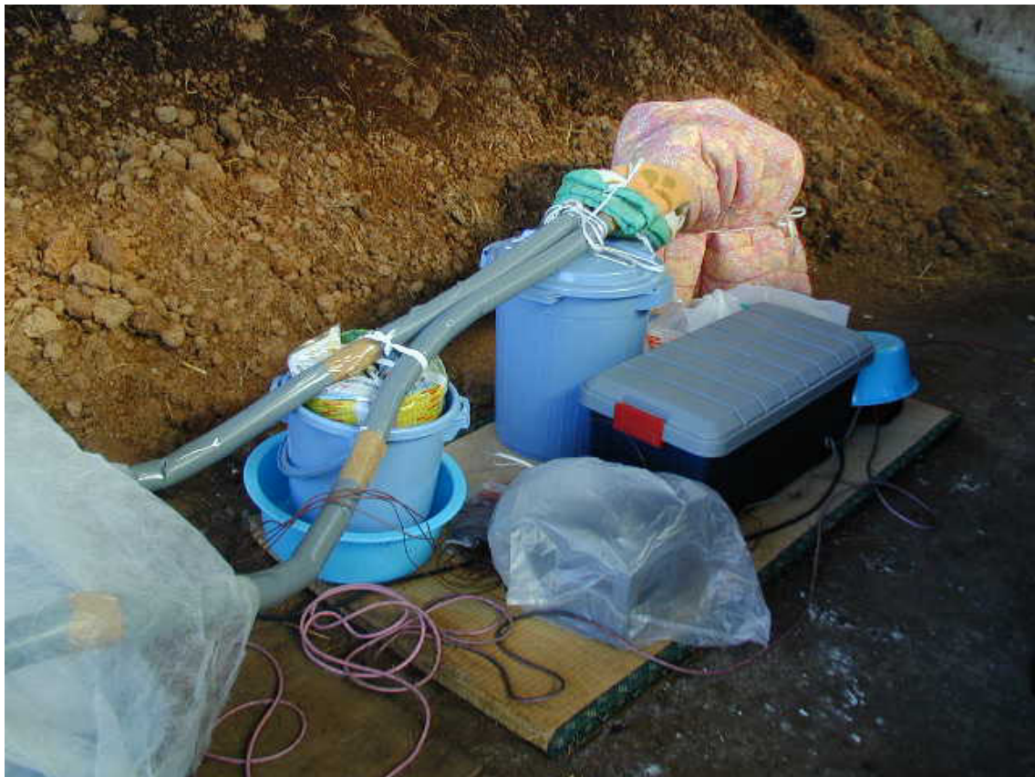
図 1 1 堆肥からの回収熱を利用した植物栽培装置の全容
