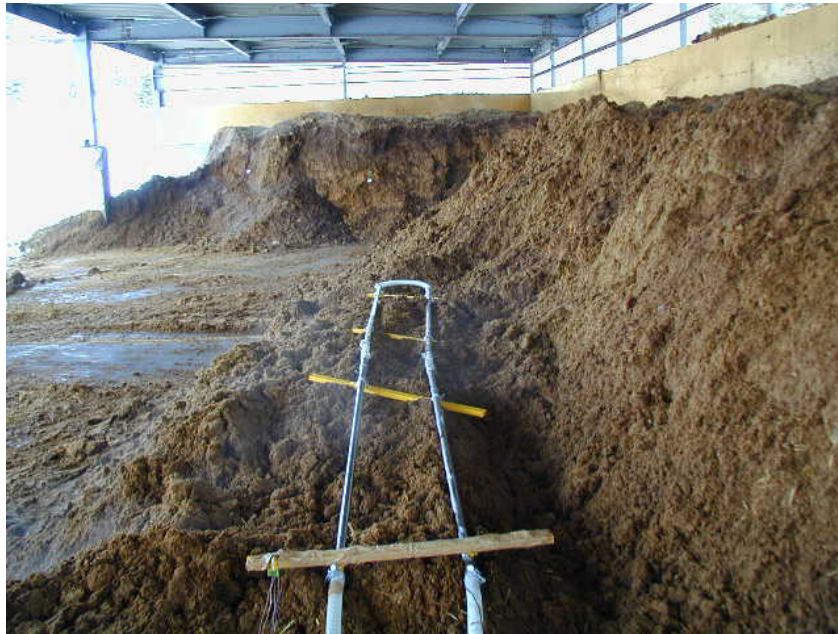
図3 堆肥パイル内に埋設した熱交換パイプ
