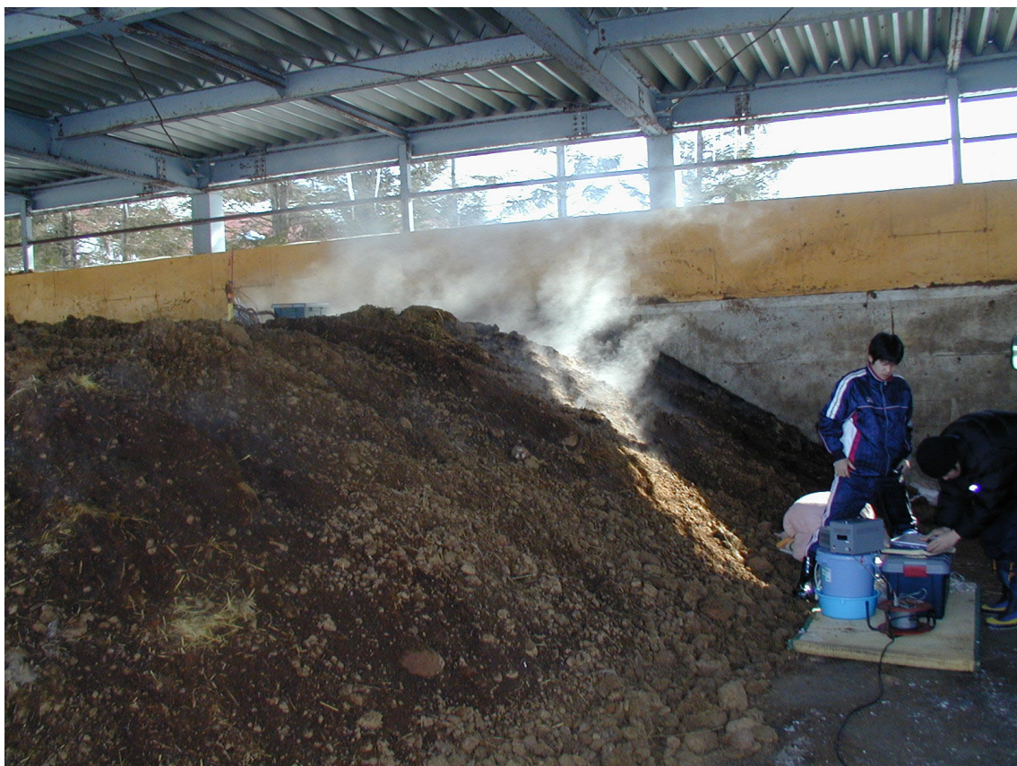
図7 堆肥からの熱回収の状況
