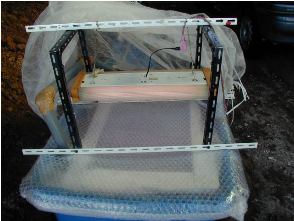
図 1 2 堆肥からの回収熱を利用した植物栽培装置における植物育成ランプによる照明
