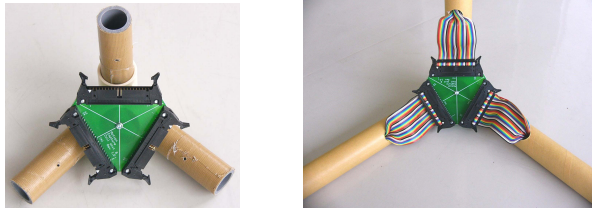
Fig. 10 励磁コイルの頂点となるジョイント部分．コイル(紙管)をさすと直交に連結される
