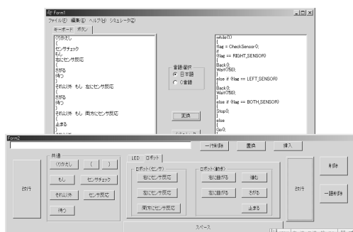
Fig. 2 ボタンによるプログラム入力画面
