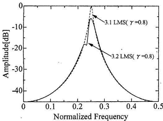
Fig.13 洩れ込み成分をノッチアウトする伝達特性
