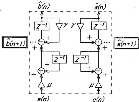
Fig.9 積分操作を加えた出力部のブロック図
