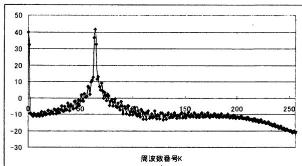
Fig.1 1[KHz]の正弦波の FFT 分析
