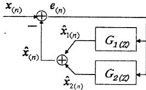
Fig.12 洩れ込み成分のノッチアウト法
