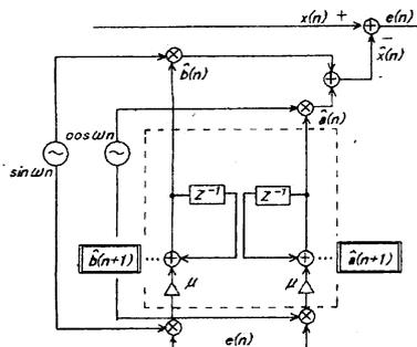
Fig.4 LMS 型フーリエアナライザのブロック図
