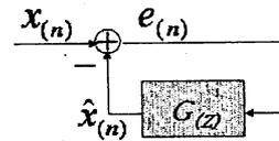
Fig.8 LMS 法のフィードバック系
