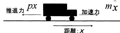
図1. 自動車の推進力と加速力
