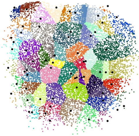
Fig. 3 特徴量空間がボロノイ型に分割された結果(ノード64)
