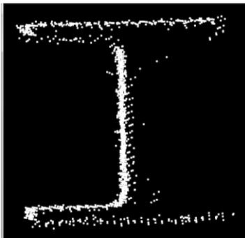
図9 H型鋼断面形状の例
