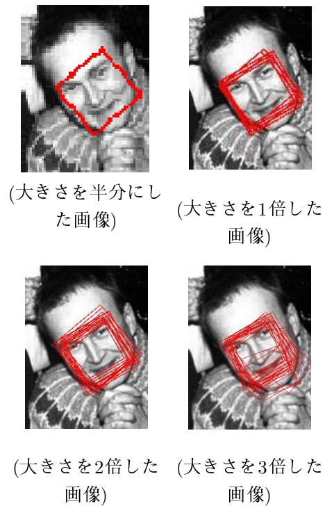
Fig. 13 画像の大きさによる検出の実験結果
