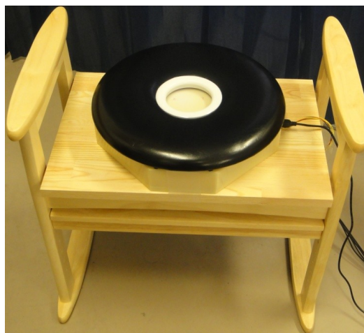
Fig. 1 実験で用いた微小変位センサ内臓の椅子
