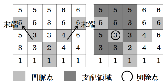
図 1 ボロノイ図を用いた支配領域推定
