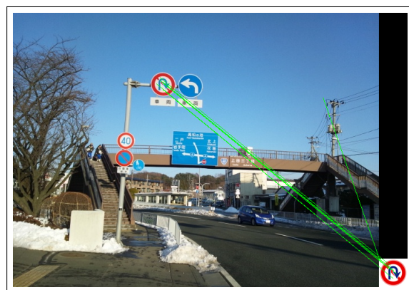
Fig. 7 特徴点マッチング結果
