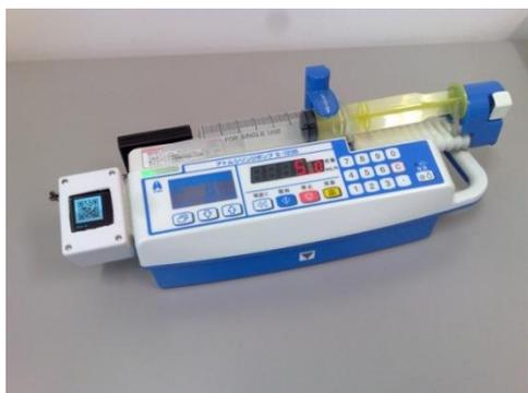
Fig. 10 QRコード表示デバイスとシリンジポンプ（正面図）
