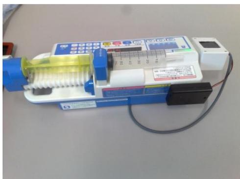
Fig. 11 QRコード表示デバイスとシリンジポンプ（背面図）
