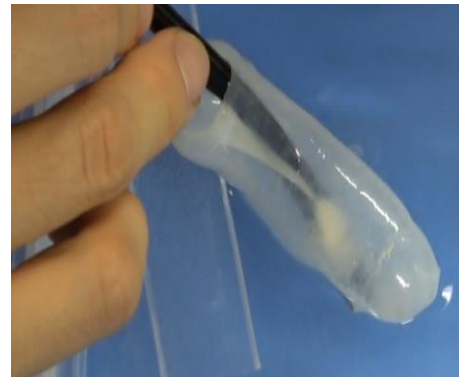
図 2 : 羊腸を用いたトーラスバルーンアクチュエータの試作機
