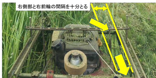
図7 右側面部分の構造
