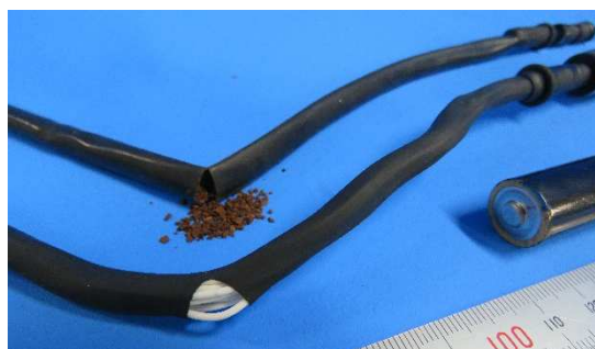
図 8：複線ジャミング内部構造
