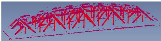
Fig.3 直線度が閾値以上の点の抽出結果
