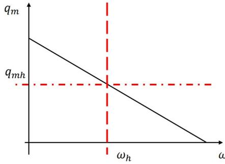
Fig. 4 ホバリング状態を基準とした DC モータにおけるトルクと回転速度の関係
