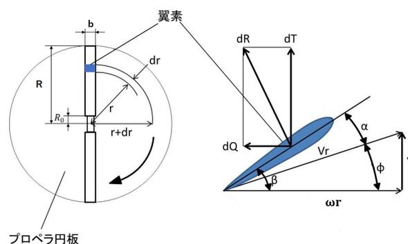
Fig. 2 プロペラの外形と翼素にはたらく推力とトルク
