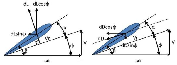
Fig. 5 プロペラの翼素にはたらく揚力と抗力
