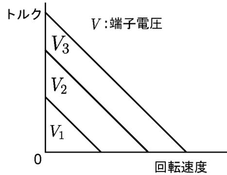
Fig. 3 DC モータにおけるトルクと回転速度の関係
