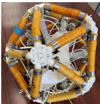
Fig. 1 正二十面体型自歪ロボット
