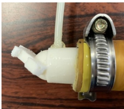
Fig. 5 人工筋肉の接続
