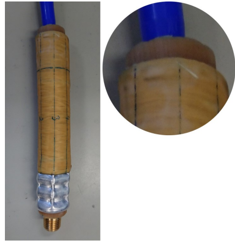
Fig. 9 二層分離型の一度目のかしめ後
