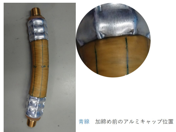
Fig. 10 二層分離型の二度目のかしめ後
