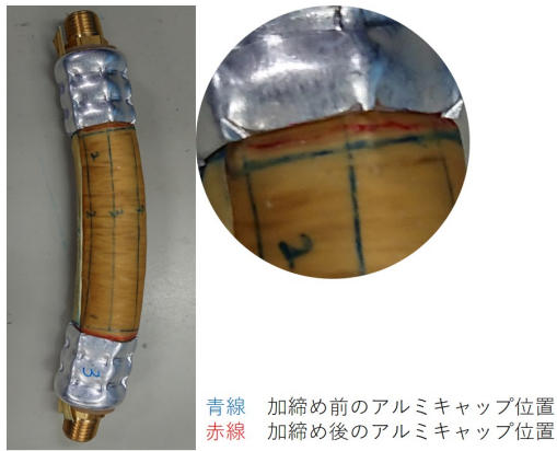
Fig. 7 軸方向繊維後付け型のかしめ後
