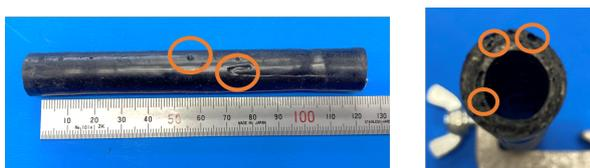
Fig. 9 改良した繊維包含シートを用いた成型物 (左) 側面 (右) 断面.
