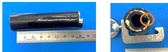
Fig. 4 シートを芯棒に巻いての成型物 (左) 側面 (右) 断面.
