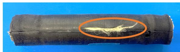
Fig. 7 破裂した箇所.
