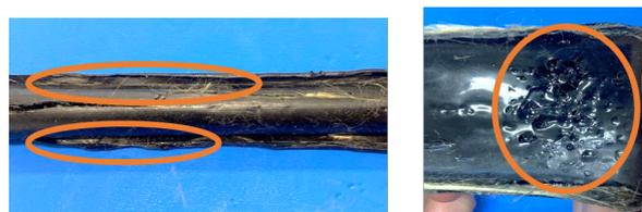
Fig. 10 加熱温度を変更した成型物 (左) 側面 (右) 内面.
