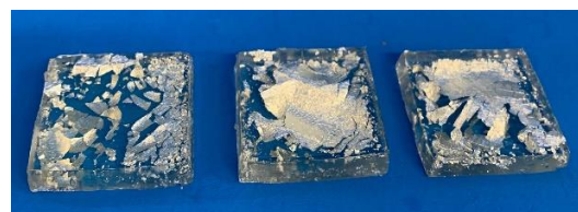
Fig. 4: 3層目にゼラチンを使用した方式の製作時の銀箔の剥離の様子。
