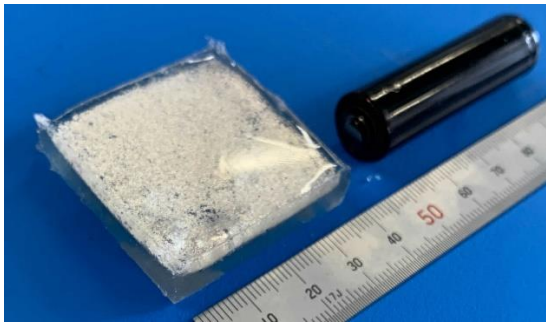
Fig. 6 : 銀粉スプレーにより2層目を構成した試作機の外観.
