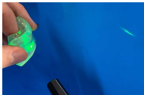
Fig. 9 : 試作機 (c)方式)による湾曲状態での光反射の様子。
