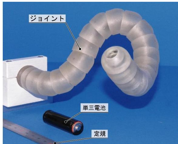
Fig. 1: 人工筋を封入した軸方向収縮型加圧式柔剛切替機構の実機外観. (本研究で新考案・具現化した実機. 特許出願準備中.)
