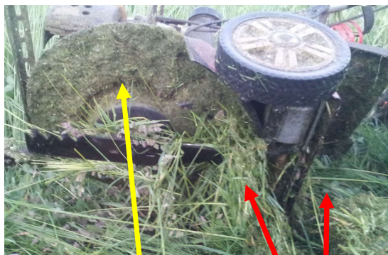
詰まり(ペースト状) (除去が望ましい) 詰まり (要除去)
