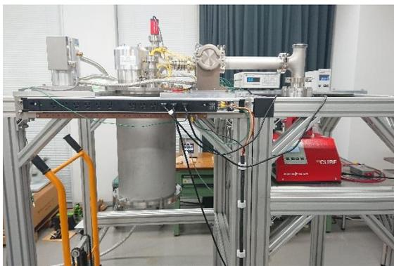
Fig. 1 極低温電子光学装置
