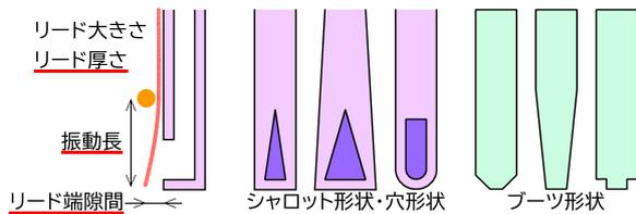
Fig. 7 リード管のパラメータ. Parameters of reed pipe.
