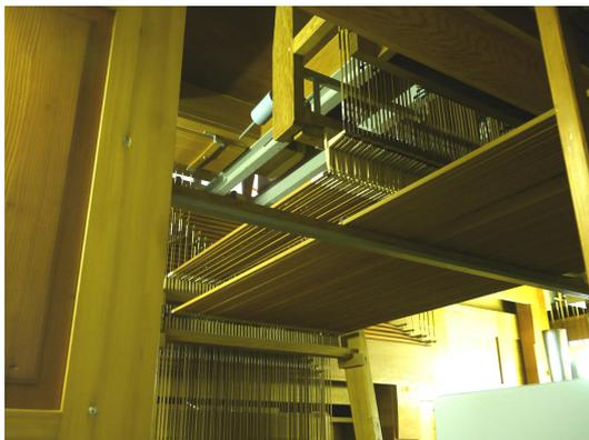
(c) 鍵盤から風箱に向かうリンク群. Links connecting console to windchest.
