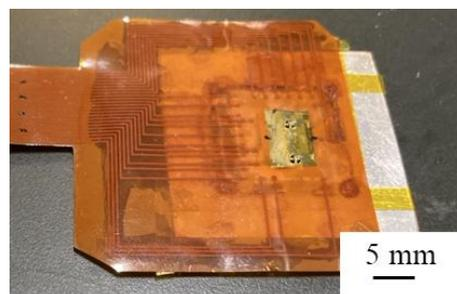
Fig. 5 Ag ペーストにより FPC と接合した後のセンサ.
