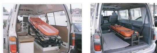
Fig. 1: 1 自由度制御型傾斜ベッド (左) と回転ベッド (右)
