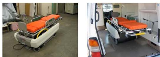
Fig. 2: 2 自由度姿勢制御型アクティブ制御ベッド
