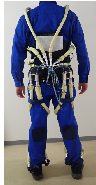
Fig. 4 農業用内骨格型アシストスーツの外観 (背面). Back view of an endoskeleton-type assist suit for agriculture.
