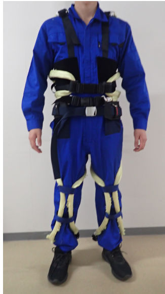
Fig. 3 農業用内骨格型アシストスーツの外観 (正面). Front view of an endoskeleton-type assist suit for agriculture.
